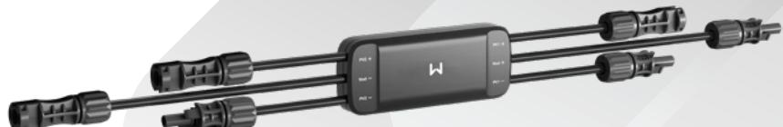
Il Rapid Shutdown (RSD) è composto da due parti, un ricevitore e un trasmettore. Il ricevitore di GoodWe è un componente chiave della soluzione RSD 2.0 per gli impianti fotovoltaici e può essere collegato a un singolo modulo. Funzionando come un dispositivo di spegnimento rapido a livello di modulo, migliora la sicurezza antincendio dei tetti e degli edifici fotovoltaici.
