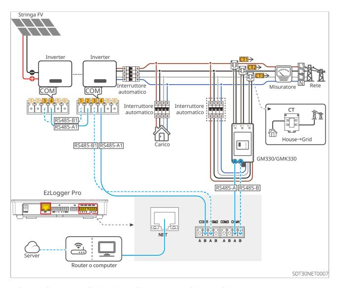
Schema di rete con limitazione di potenza multi-macchina (EzLogger3000C+GM330)
