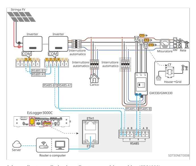
Schema di rete per limitazione di potenza multi-macchina (SEC1000)
