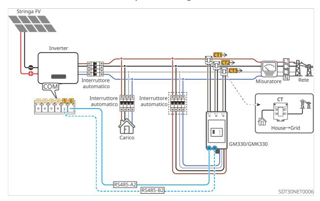
Schema di rete per limitazione di potenza multi-macchina (EzLogger Pro+GM330/GMK330)
